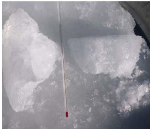
上左图是 2012 年 3 月初当雄错盐湖东岸跨过桥涵、跨过公路的涎流冰，这也是冷季高原行车需要注意的一个凶险。右侧是我将多格错仁盐湖密度 1.1 左右的卤水在当雄错盐湖于 2011 年 1 月初（农历腊八）冷冻结冰的情况（环境最低温-26，地温-29）。冻结的冰较厚，也有一点强度，但因在不锈钢盆中，冰的冻胀力与钢的冷缩力双重作用下，冰多细小冰裂即看起来不透，而多白渣。
