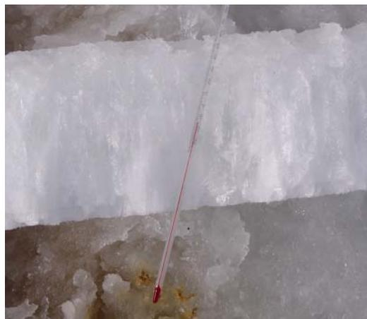
2010 年底-2011 年初多格错仁盐湖，在冰上取卤，寒冬腊月这 15-20cm 厚的纵纹冰具有较高支撑强度，但抗开裂强度极差，我只是破个洞要测下取卤点的深度，就让我一条腿陷落。
