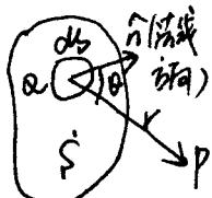
波面  $S$  上每小面积元  $ds$  都可以看成是新的波源。它们均发出球面次波。波面  $S$  向空间某一点  $P$  的振动而要看成是  $S$  表面上所有面积元发出的次波在空间引起振动的振幅之和。而点  $ds$  处的振动  $dU(p) = \frac{A(\theta)}{r} e^{i\omega t} k(\theta) ds$
